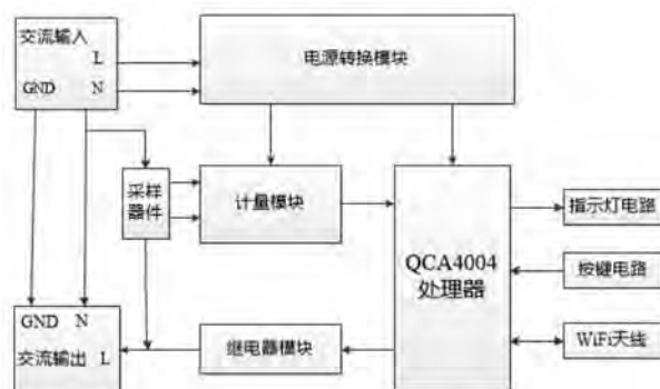
图 1 智能插座系统设计框图
