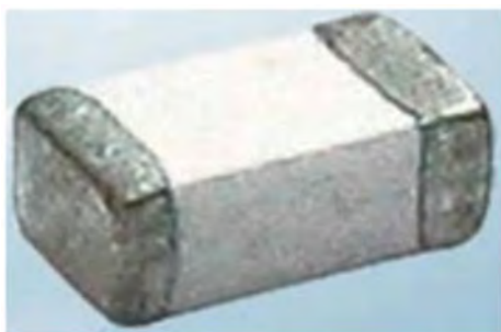
图4 独石工艺生产的贴片保险丝产品
