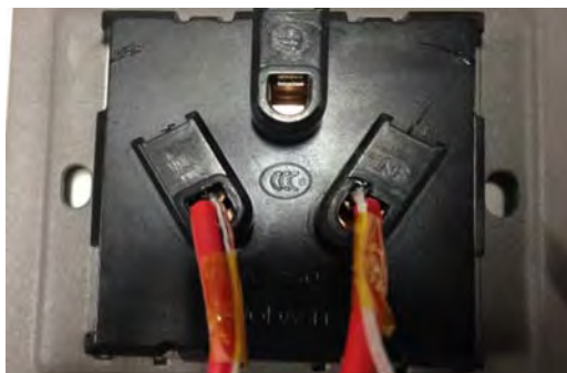
图 1.1 试验样品热电偶布点情况
