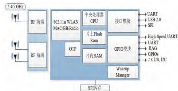
图 2 QCA4004 的系统结构框图
