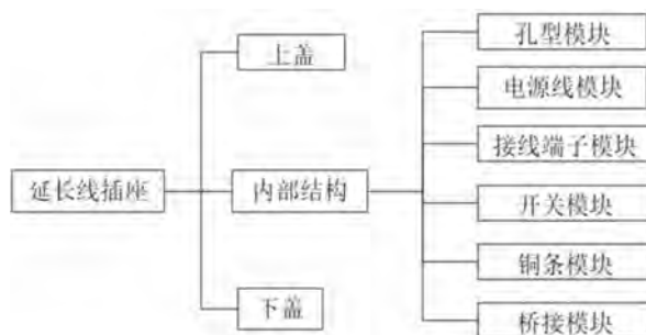
图 1 延长线插座结构组成
