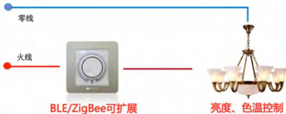
图 3 D.L.CON 调光调色温控制原理图
